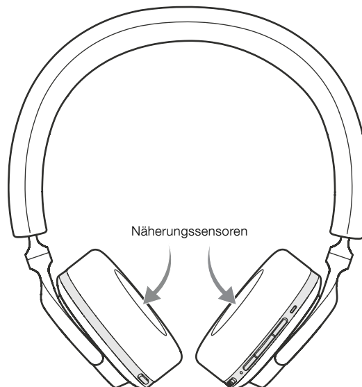
Abbildung 4 Position der Näherungssensoren
